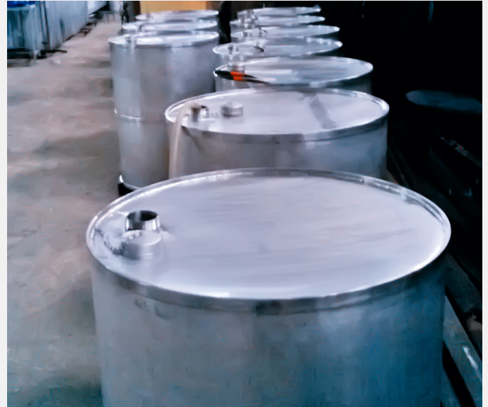
Chế tạo bồn chứa hoá chất cho công ty Henkel Chứa hóa chất trong ngành chế biến thực phẩm mỹ phẩm, chất tẩy.
