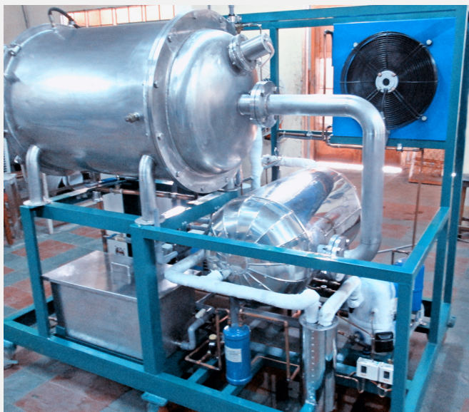
Chế tạo & lắp đặt hệ thống máy sấy thăng hoa Sấy trái cây và thực phẩm
