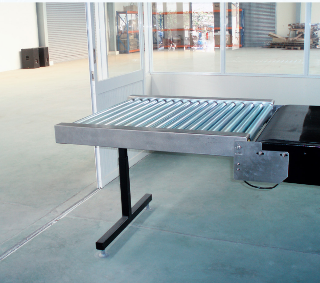
Chế tạo và lắp đặt băng tải con lăn Dùng để vận chuyển sản phẩm trong ngành công nghiệp
